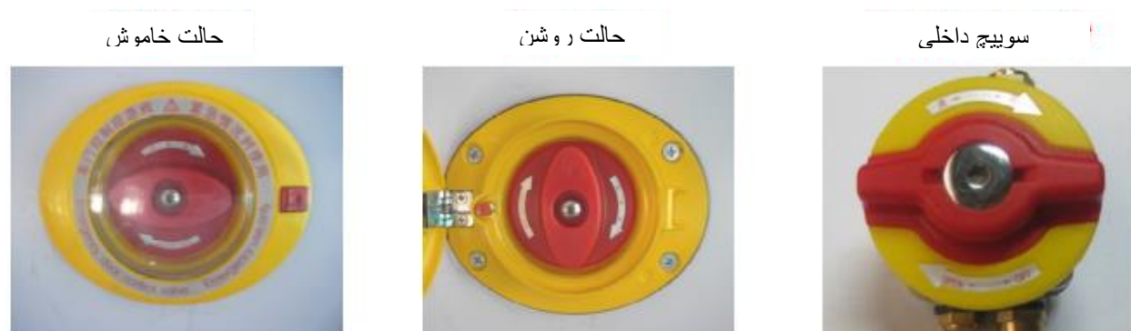
شکل ۳-۳: سوئیچ اضطراری درب سرنشین (بروی داشبورد)
